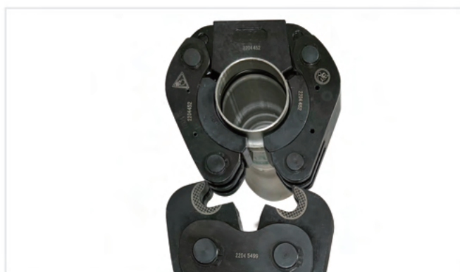
3、放入管件，合上壓接模具
